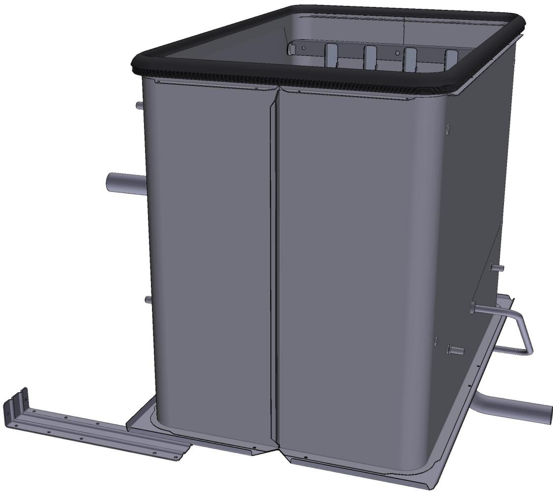
**ASM2853B/0.D00 - Camera di cottura**
